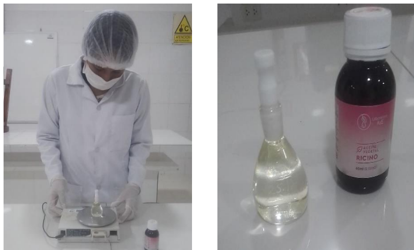
Figura A7. Se pesó el picnómetro con el aceite vegetal para determinar su masa, permitiendo calcular la densidad mediante la relación masa/volumen.
