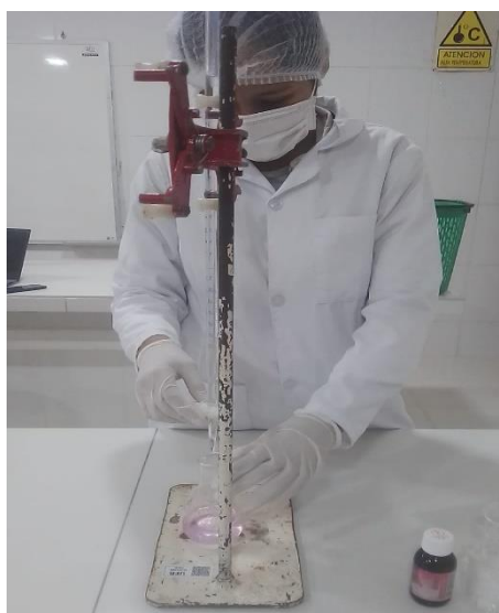
Figura A4.1. Desarrollo del ensayo de titulación para la determinación del índice de acidez del aceite de Ricinus communis .
