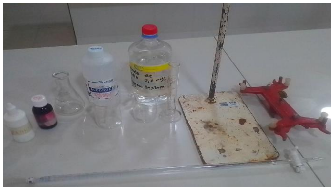
Figura A4. Instrumental y reactivos empleados en la determinación del índice de acidez del aceite de Ricinus communis .
