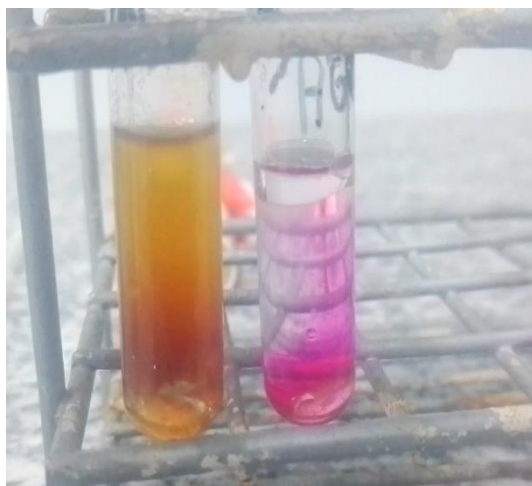
Figura A5.1. Se observa en la imagen la decoloración del color púrpura, lo que evidencia la presencia de insaturaciones en el aceite.
